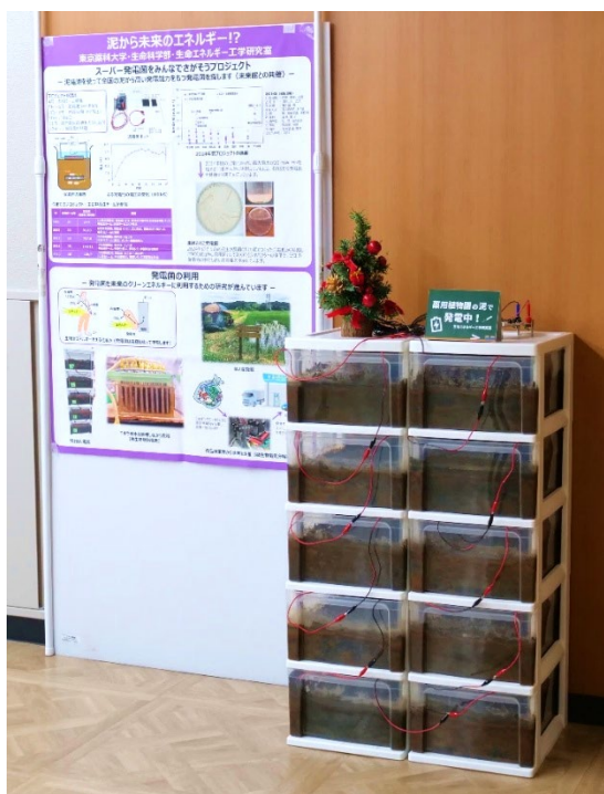
(左) 展示全体図: 泥と電極を入れたプラスチックケースの中で電子が生まれ、電池のはたらきをしている (右) LED 点滅テストの様子
