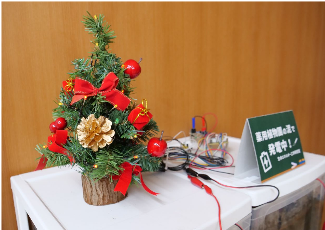
(上) クリスマスツリーに付けた LED 電球が泥電池で発光している
