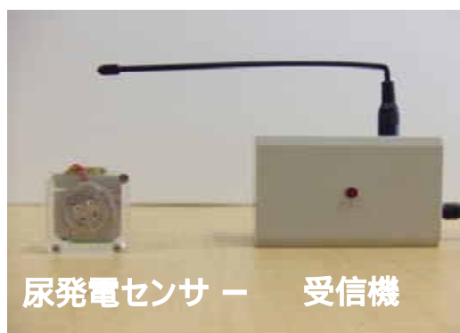
図1 尿発電によるワイヤレス尿漏れセンサーシステム
