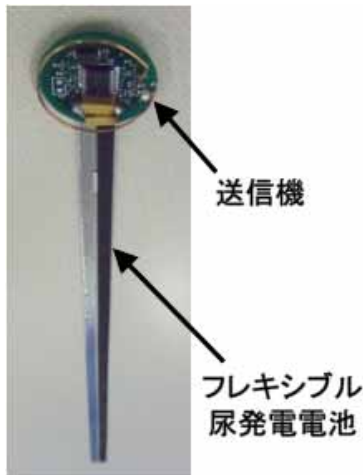
図2 おむつ用尿発電センサー
