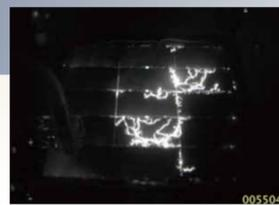
太陽電池パネル上での放電(地上試験)
