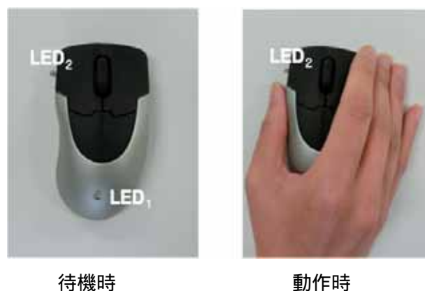
図 1 可視光 LED 発電による起動回路を備えたワイヤレスマウス
