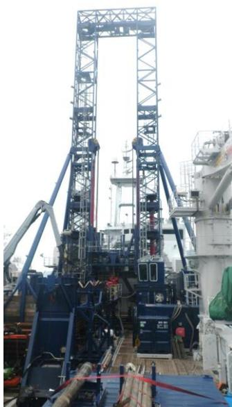
▲白嶺の船上設置型掘削装置 R140
