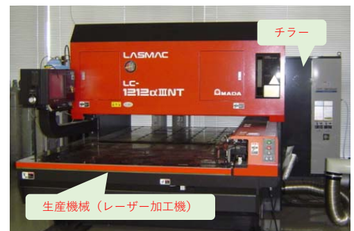
図1 ものづくり大学における例(生産機械とチラー)
