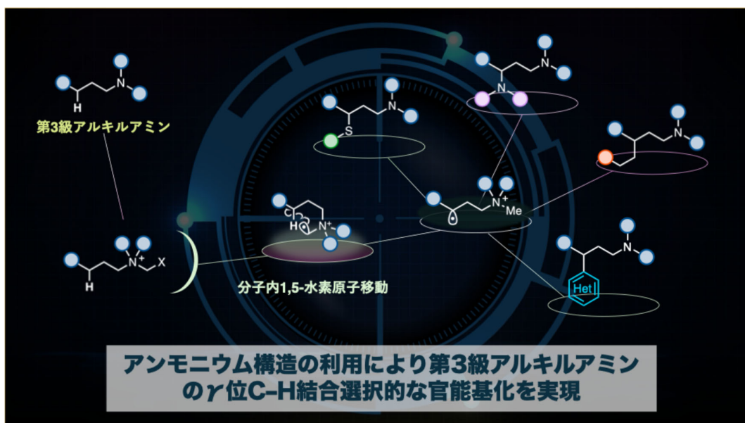
図 1：本研究で開発した反応の概要。 \alpha -アンモニオラジカルを利用することで、第3級アルキルアミンの \gamma 位 C-H 結合のみを選択的に官能基化することが可能になった。
